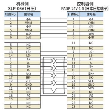
型号 **CB-CFA2-MPA** □□□/ **CB-CFA2-MPA** □□□-RB
