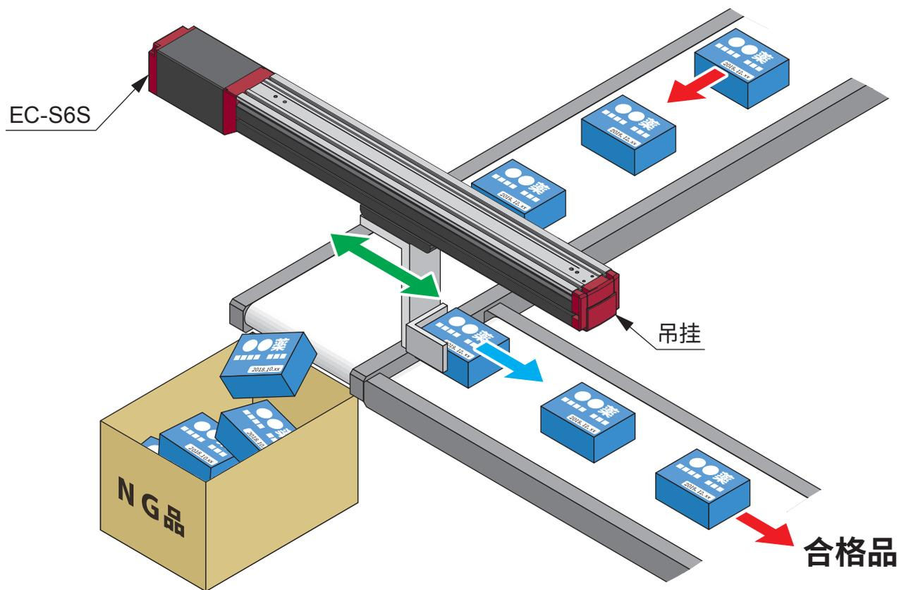
**说明** 以往使用气缸来搬出合格品，但是如果为了缩短周期时间而提高气缸速度，停止时的冲击就会很大，合格品的搬出位置会发生偏移，导致在后面的工序中出现短停。
